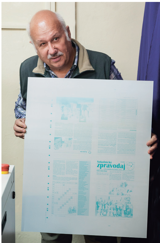
Pro tisk jedné strany archu jsou potřeba čtyři takovéto tiskové desky, pro každou tiskovou barvu CMYK jedna, dohromady tedy osm desek
