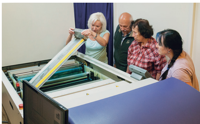
Tak to je on – Computer To Plate pro vytváření ofsetových tiskových desek...
