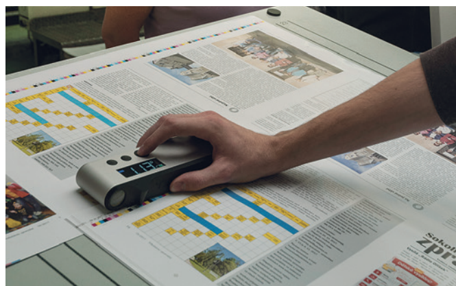
Pečlivá kontrola denzity prvních potíštěných archů je důležitá pro kvalitní tisk celého nákladu zpravodaje
