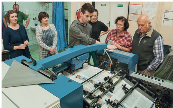
Žáci SŠG předvádí komisi tisk zpravodaje na dvoubarvovém tiskovém stroji (tisknou se dvě barvy během jednoho procesu, každý tiskový arch projde strojem čtyřikrát)
